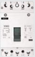
Termik Ayarlı Kompakt Şalter, VMT In : 16A – 400A Icu : 35kA, 50kA I r : 0.7 – 1 In
